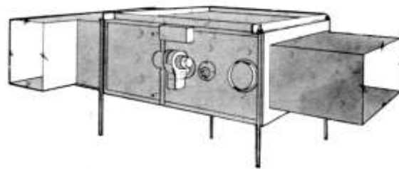
شکل (۶-۱۳) نوع افقی - قابل نصب در زیر سقف - هوای رفت و برگشت توسط کانال
